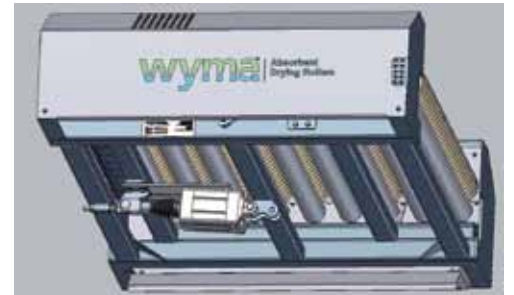
Cilindro exprimidor para eliminar el exceso de humedad de los rodillos de esponja
