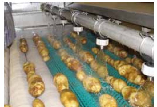
Patatas pasando por un Sistema modular de cama plana Wyma con barras pulverizadoras
