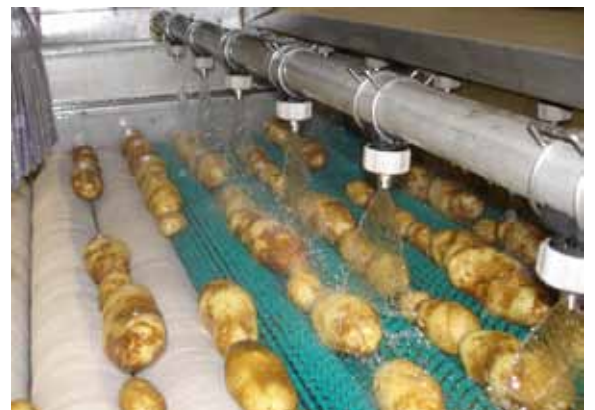
Batatas passando pelo Sistema Modular de Cama Plana Wyma com barras de pulverização
