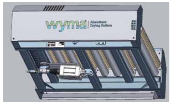
Cilindro de compressão para remover o excesso de humidade dos rolos de esponja
