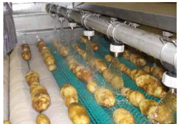
Ziemniaki przechodzące przez płaski system modułowy wyposażony w spryskiwacze
