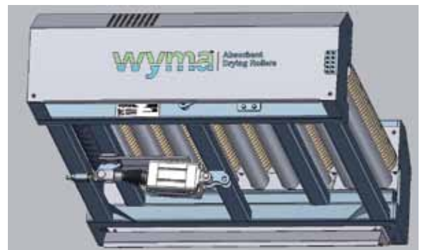
Siłownik wyciskający dla usunięcia nadmiaru wilgoci z rolek gąbkowych
