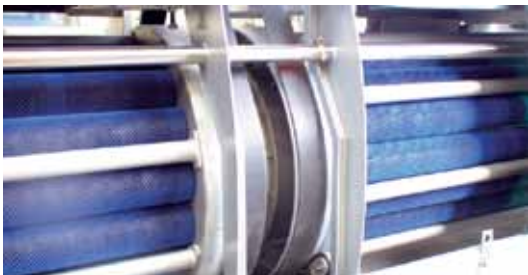
Bębny przejściowy dający efektywny przepływ produktu pomiędzy beczkami
