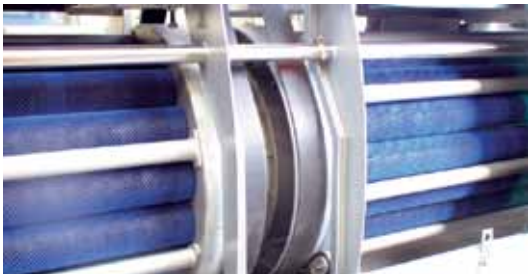
バレル間に農産物を効果的に流すための連結ドラム
