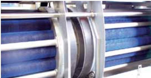
Fördertrommel für den effizienten Transport des Produkts zwischen den einzelnen Trommeln
