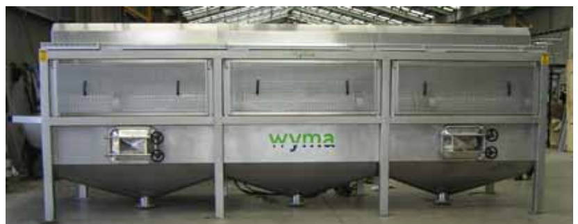
Lavadora de tambor Wyma de acero inoxidable de seis metros con cargadores de salida
