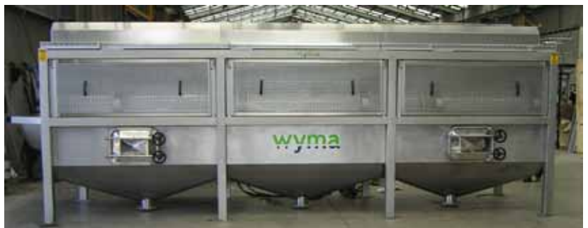
Sześciometrowa myjka bębnowa ze stali nierdzewnej Wyma Barell Washer z czepakiem.
