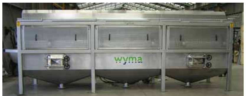
6メートルのステンレス鋼 排出シャベル付きワイマ バレル・ウォッシャー
