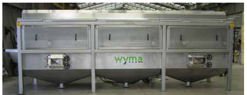
6 Meter lange Wyma Trommelwaschmaschine aus Edelstahl mit Austrageschaufeln
