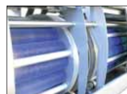
2 x 16 rzędów szczotek połączonych modulem sprzęgającym
