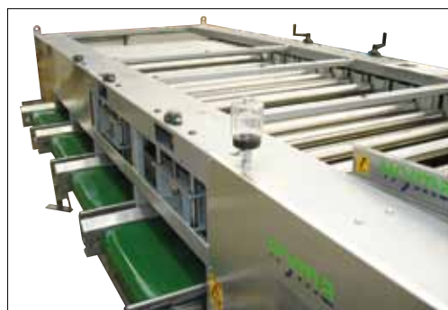
Sortownik z unoszonymi wałkami z prostymi wałkami
