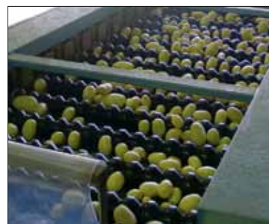
Sortownik z unoszonymi wałkami z wałkami owalnymi i ziemniakami
