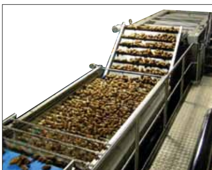
Absorbujące wałki suszące Wyma z ziemniakami
