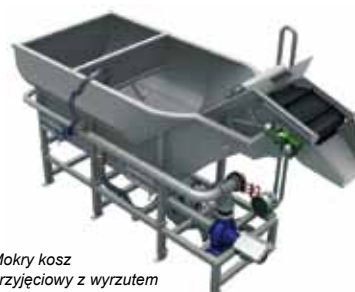
Mokry kosz przyjęciowy Wyma z funkcją usuwania kamieni przez podnośnik
