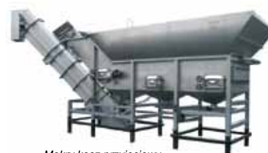
Mokry kosz przyjęciowy Wyma z funkcją usuwania kamieni przez podnośnik
