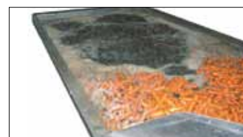
Carottes brassées par l'agitateur à air
