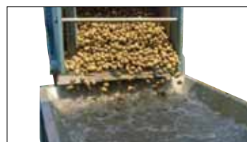
Pommes de terre basculées depuis une caisse dans une trémie humide Wyma
