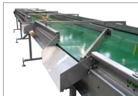
Lattes pour convoyer le produit vers les goulottes de sortie
